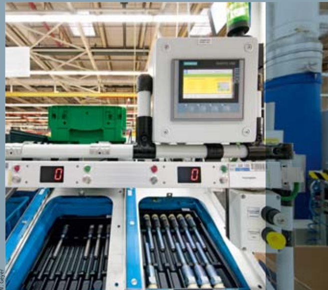
Zur Visualisierung an den Lagerplätzen dienen Simatic Comfort Panels
